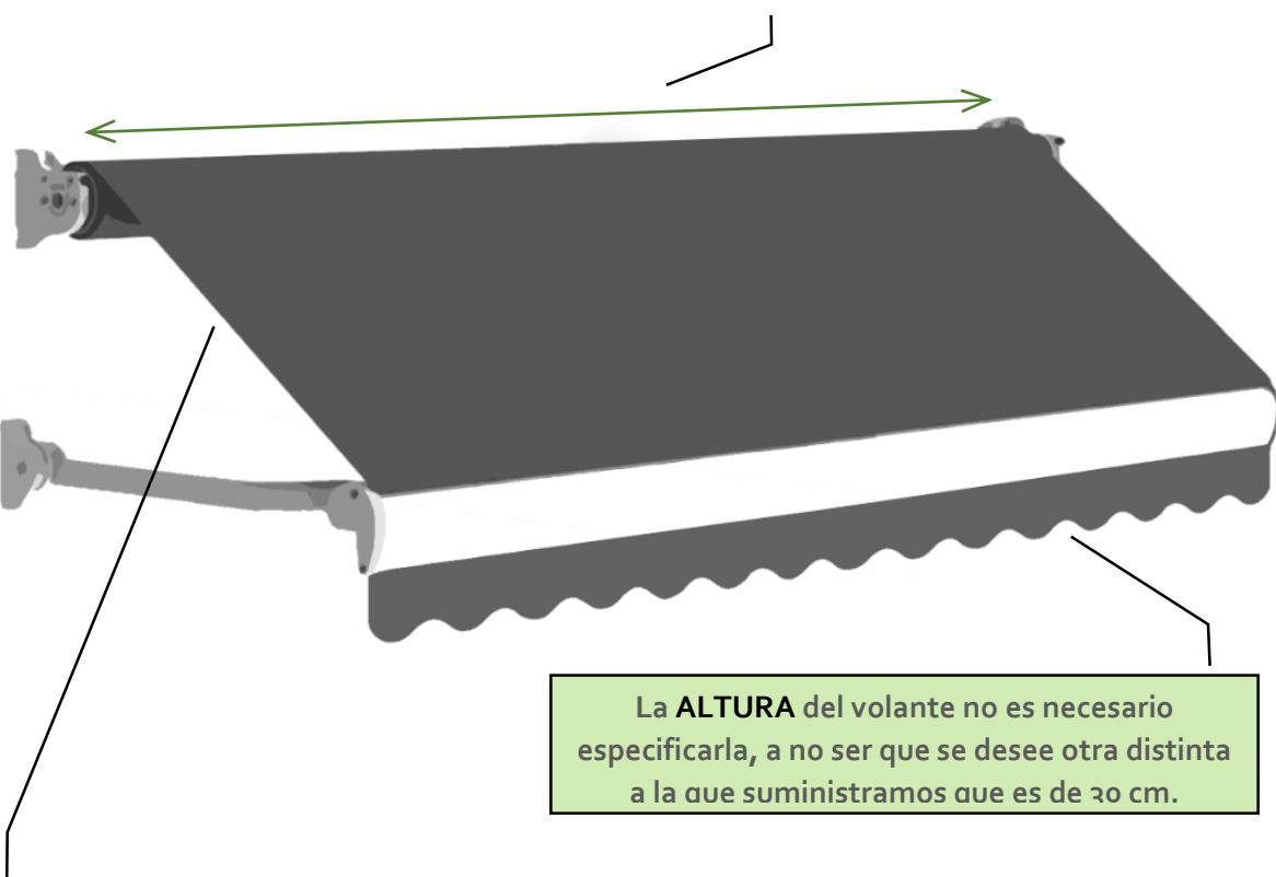
**La LÍNEA** es el ancho total de la lona, es aconsejable medir sobre 1cm menos del tubo de enrolle, para que la lona quede tensa una vez colocados los tornillos que la sujetan.
